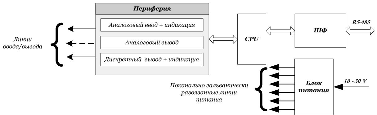
Рис 1. Обобщённая структурная схема модулей дискретного ввода-вывода WAD-FLAME-BUS.
