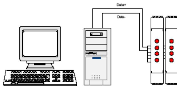
Если вычислитель не имеет встроенного интерфейса RS-485, то необходимо использовать преобразователь интерфейса RS-485/RS-232 типа WAD-RS232/485-BUS, или аналогичный.
