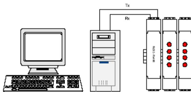
Каких-либо особенностей подключение интерфейса не имеет, нужно только учитывать, что допустимая протяжённость линии связи интерфейса RS-232 не превышает 10-20 метров, в то время как RS-485 позволяет проводить связь на расстоянии более километра. Чем длиннее линия связи, тем ниже будет максимально возможная скорость обмена. “Стандартной” является скорость 9600 бод, которая достаточна для решения подавляющего большинства задач.
