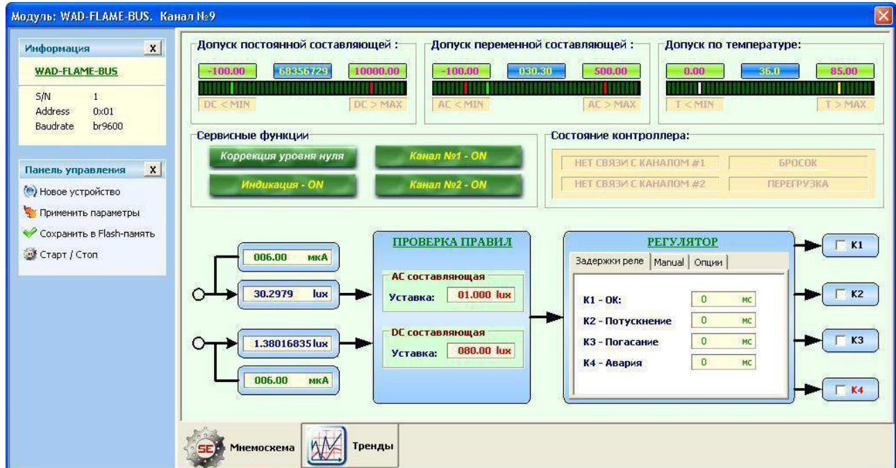
Канал «Flame» считывает значение переменной и постоянной составляющей с указанного канала фотодатчика (фотоканал). Можно выбрать либо оба канала одновременно, либо один из двух фотоканалов. Если выбраны оба фотоканала, то Flame-канал опрашивает первый фотоканал, но если он выходит из строя то автоматически начинает опрашивать второй фотоканал, при этом через каждые 5 секунд делает попытки восстановить связь с первым фотоканалом.
